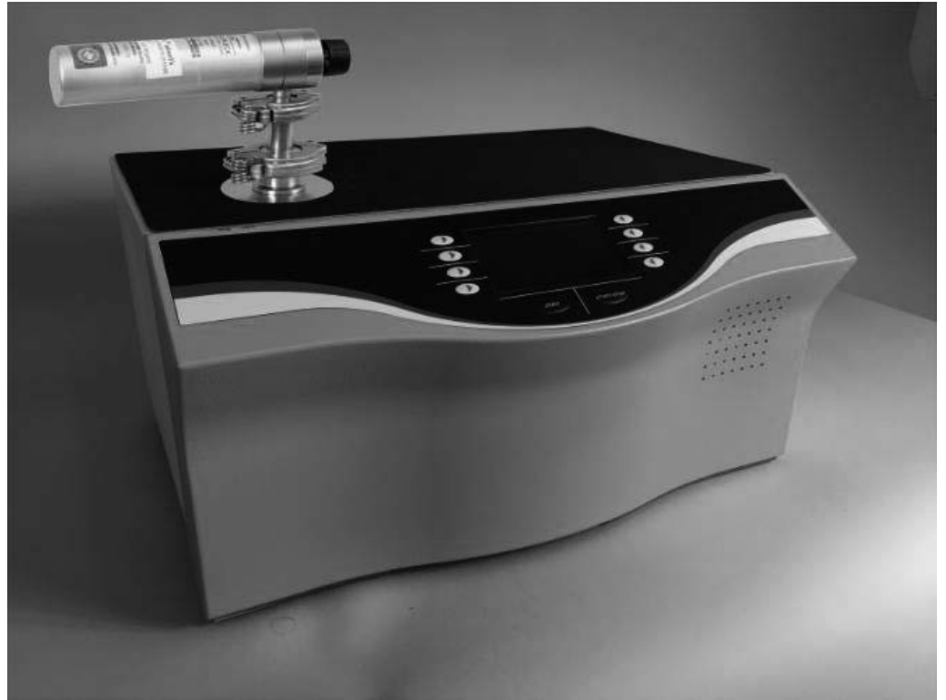
插图 15: 检查外部漏孔
