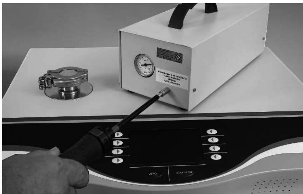
插图 17: 外部漏孔上进行嗅探检查
